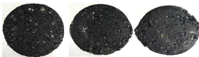
Figura 4 – Corpos de prova após rompimento na prensa Marshall: (esquerda) CAP 10/20, (centro) CAP 30/45 e (direita) CAP 50/70
