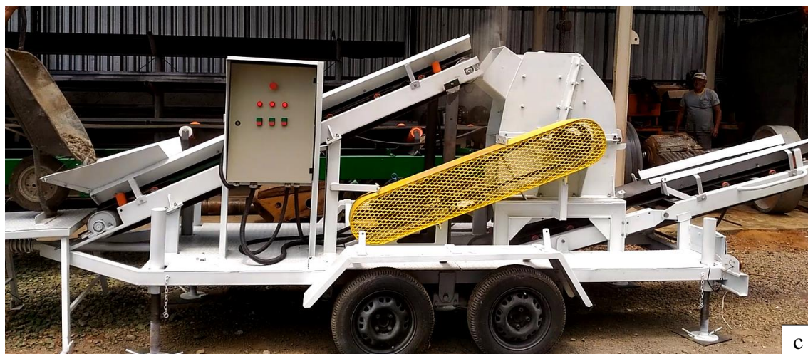
Figura 1 - Usina móvel desenvolvida no projeto Legenda: a) Módulo de britagem; (b) Módulo de qualidade e c) Módulo de moagem Fonte: Os autores (2020)
